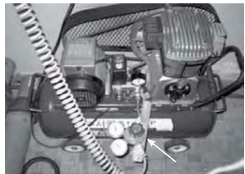
Рисунок 3. Компрессор, обеспечивающий подачу воздуха под давлением с регулятором давления (стрелка) (ОИТ, Монголия).
