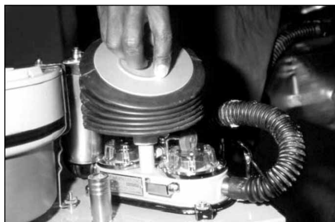
Рисунок 6. Магнит, регулирующий клапан: система оксфордских мехов
